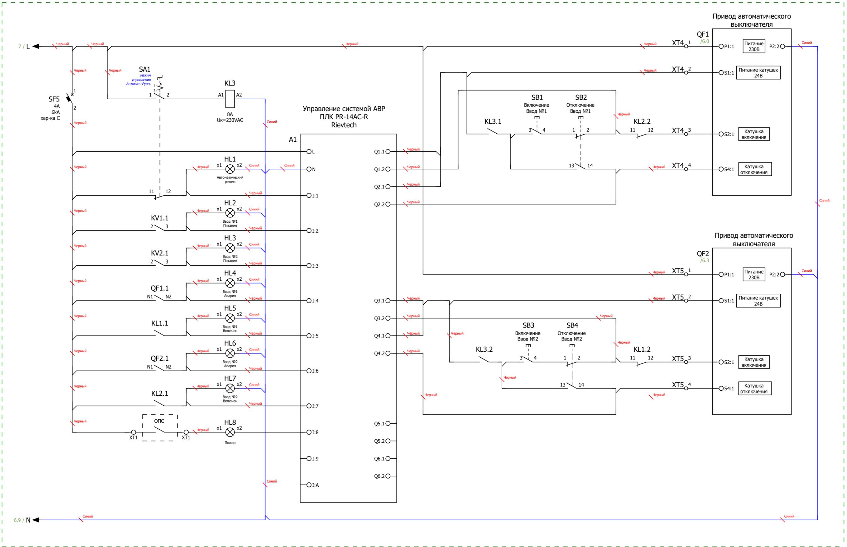
Схема управления АВР и индикации
